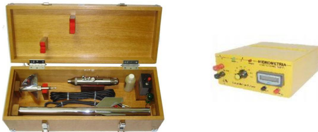
**Figura 9 – Molinete fluviométrico Newton.**
