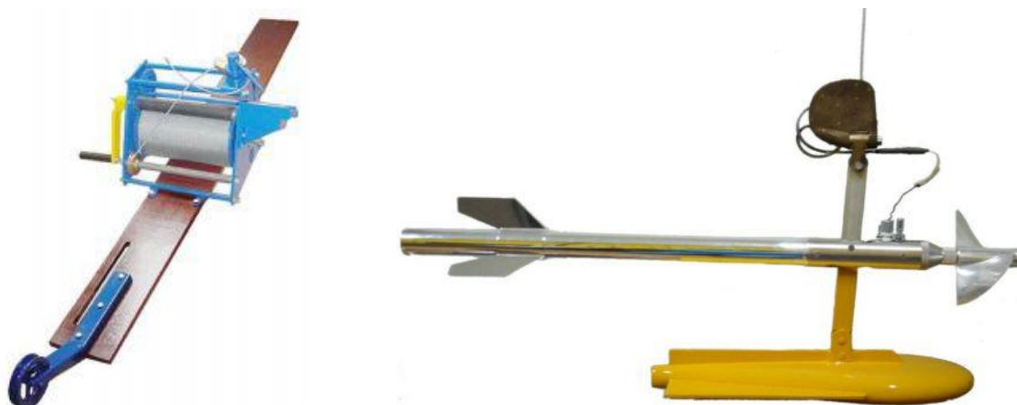
Figura 10 - Molinete fluviométrico com guincho para medições a barco.
