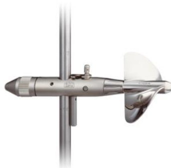
Figura 7 – Exemplo de molinete preso à haste.
